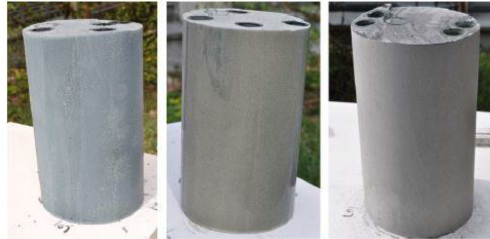
Abbildung 4-20: Exemplarische Darstellung von Versuchsstücken mit sehr guter Verfüllqualität (von links nach rechts: EWS 5-3, EWS 6-2, EWS 8-2)
