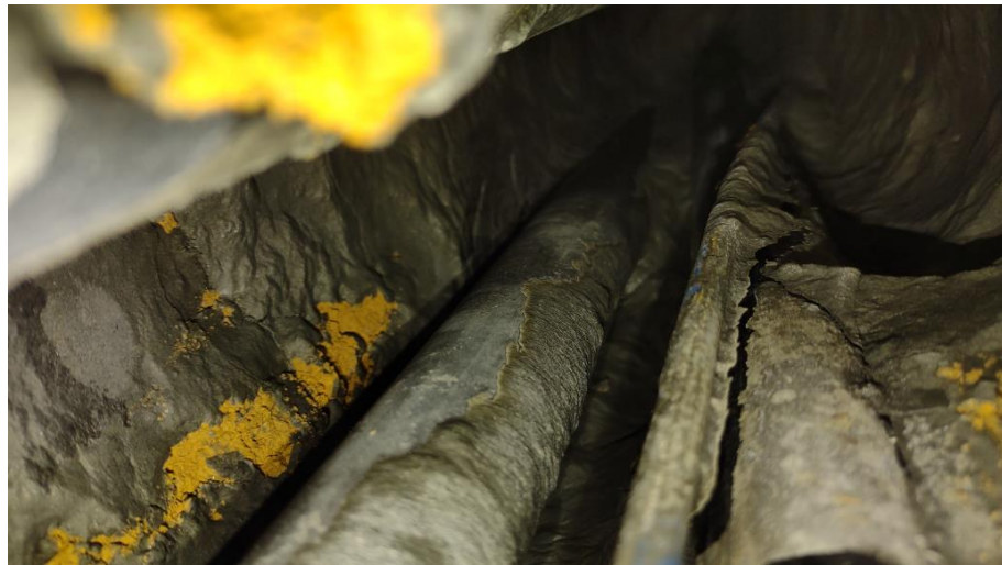
Lunker im Übergangsbereich zum Kalkstein an Sonde 6, von innen fotografiert
