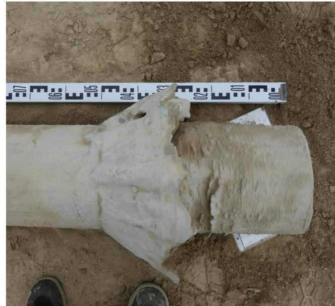
Diese Strukturen befinden sich im verrohrten Bereich und entstehen durch Druckstöße beim Bohrprozess (Wechsel der Verrohrung).
