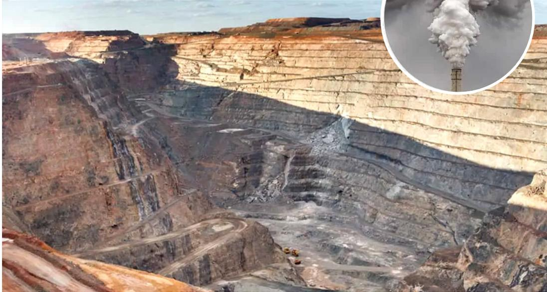
Hartgesteinsabbau für Lithium in Australien und China. Nach Abbau muss das Gestein durch Einsatz fossiler Brennstoffe hydro- und pyrometallurgisch aufgearbeitet werden, um Lithiumhydroxid herzustellen. Dies ist ein sehr CO<sub>2</sub>-intensiver Prozess.
